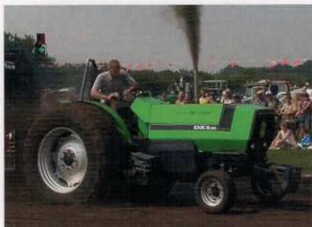
« De eerste editie van de Twister, de Deutz DX 6.30. Er werd nog een jaar met pullerbanden geëxperimenteerd, toch bleken deze Michelins geschikt voor de combinatie
