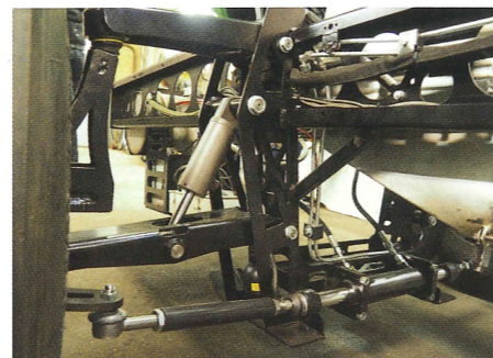
« Het nieuwe frame heeft voorasvering om klappen te kunnen opvangen.
