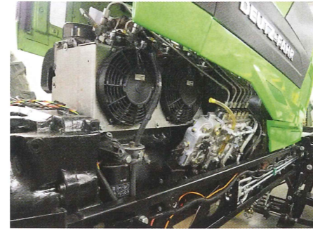
« De motorkoeling van de Deutz is gemaakt door de gebroeders Boer.
