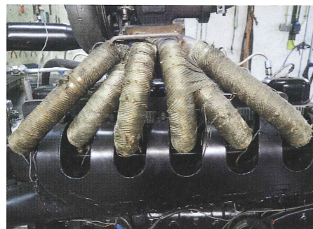
« Het uitlaatspruitstuk is omwikkeld om zoveel mogelijk warmte vast te houden.
